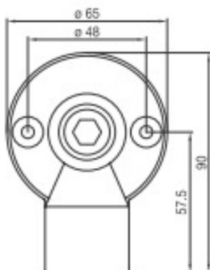
Kegelradgetriebe passend zu Sicherheitsfaltladen Secure FL1000.
